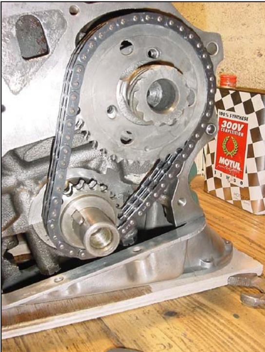
Une fois les vis remontées, il faut vérifier en remontant le comparateur que l'admission est bien ouverte de 0.4 mm en plus que l'échappement au point 0° (PMH)
