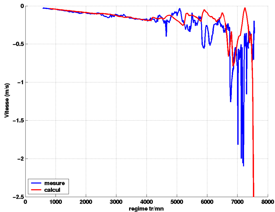
FIG. 6.10 – Vitesse avant rebond en fonction du régime, comparaison du calcul Valdyn et de la mesure
